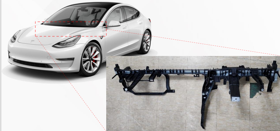
〈Steel/Composite Hybrid CCB〉
