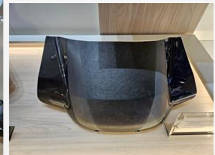
〈열경화성 CFRP 적용 시트 및 후드〉
